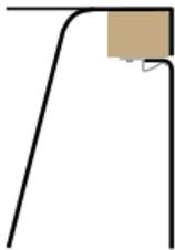
Richten Sie dann die Klemmen am Rahmen zur Verkleidung aus. Anschließend wird die Verkleidung zwischen Wannenrand und Verkleidungsklemme geschoben. Achten Sie darauf, dass die Verkleidungsklemmen nicht zu fest angezogen werden, damit die Verkleidung noch eingeführt werden kann.
