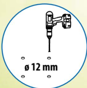
Die Löcher zur Bodenplattenbefestigung vorbohren und die Bodenplatte mit geeigneten Erdankern aufdübeln.
