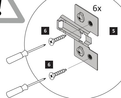
2. Sicherungsschrauben montieren.
