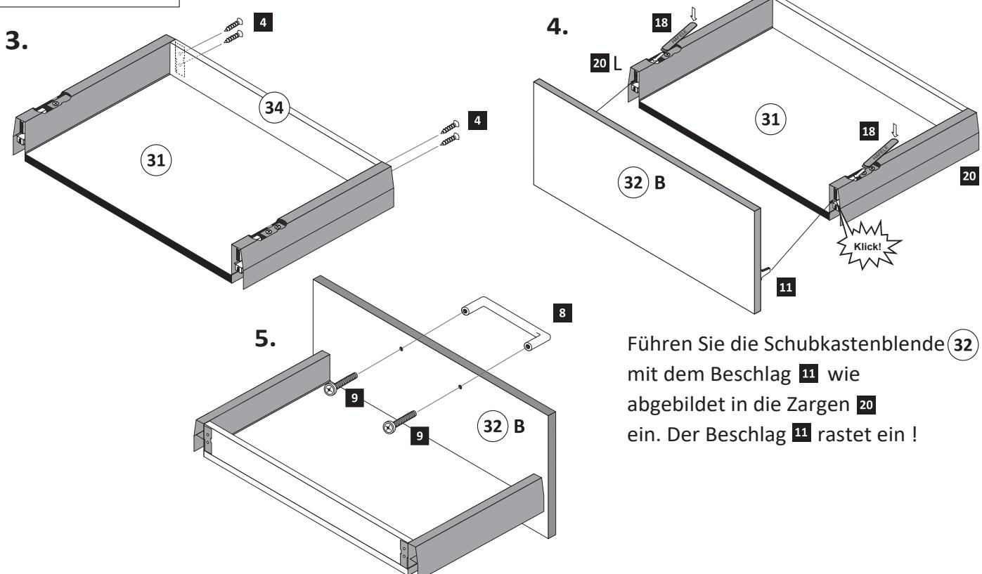
Führen Sie die Schubkastenblende (32 B) mit dem Beschlag (11) wie abgebildet in die Zargen (20) ein. Der Beschlag (11) rastet ein!
