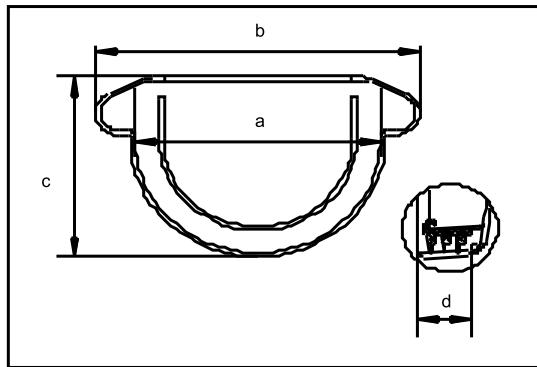
Mit einem Endstück lässt sich das Ende einer Dachrinne durch eine Steckverbindung verschließen.
