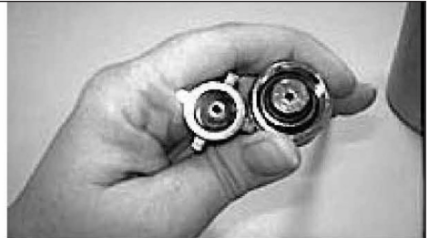
O-Ringe an der CO2-Leitung
