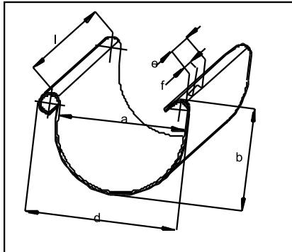
Das Nocke -Nut-System bei Dachrinne und Rinnenverbindungsschale bei Dachrinne und den Ecken verhindert ein Verbeulen und Auseinanderrutschen bei Temperaturschwankungen.
