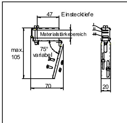
Zum Befestigen der Dachrinne bis RG 100 mit dem Rinnenhalter aus Kunststoff an Welle 8 -130/3 und Profil 76/18 (kleingewellt) und an Stegdoppelplatten. Klemm -Möglichkeit für drei Materialstärkereiche:
