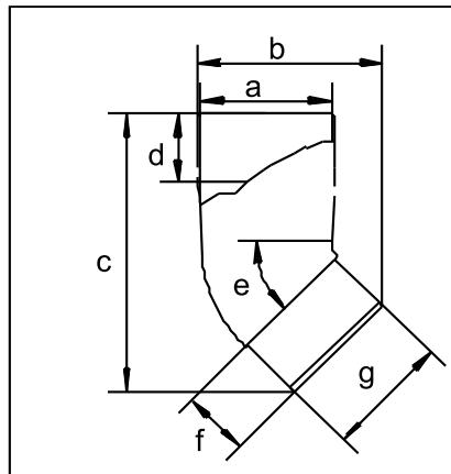
Mit Hilfe des Bogens 45° sind Verbindungen zwischen Fallrohr und Stutzen oder zwischen zwei Fallrohren möglich. Zur Verbindung von zwei Bögen muss ein Fallrohrstück oder der Bogenverbinder zwischengesetzt werden.
