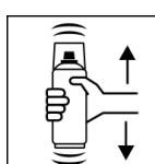
Setzen Sie einen der zwei Sprühköpfe mit einer leichten Drehbewegung wieder auf die Spraydose. Schütteln Sie diese gründlich für 1 Minute, so dass sich die Farbpigmente gleichmäßig verteilen.
