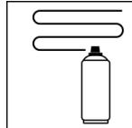
Halten Sie die Dose senkrecht und sprühen Sie dann mit einem Sprühabstand von 15 - 25 cm im Kreuzgang mehrere dünne, nebelnde Schichten. Beginnen Sie dabei immer außerhalb des Objekts.
