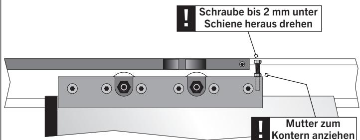
**10 Selbsteinzug justieren**
