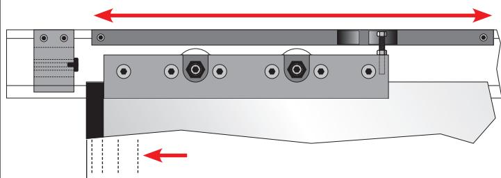
**11 Abdeckprofil auf Schiene montieren**
