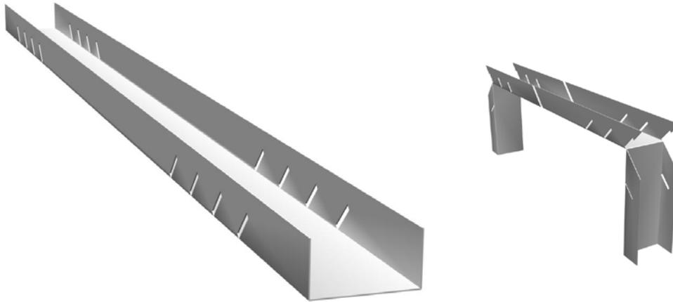
Rigips Türsturzprofile sind korrosionsgeschützte Metallprofile, die als Sturzprofil zur Erstellung von Türöffnungen in leichten Trennwänden dienen. Die Profile verfügen über Vorstanzungen für standardisierte Bauöffnungsmaße und sind in den Steghöhen 50, 75 und 100 mm verfügbar. Vor Montage erfolgt lediglich ein schräges Einscheiden der Flansche an den betreffenden Vorstanzungen und das Umbiegen der jeweiligen Enden. Rigips Türsturzprofile werden aus Stahlblech nach DIN EN 10327 gefertigt.
