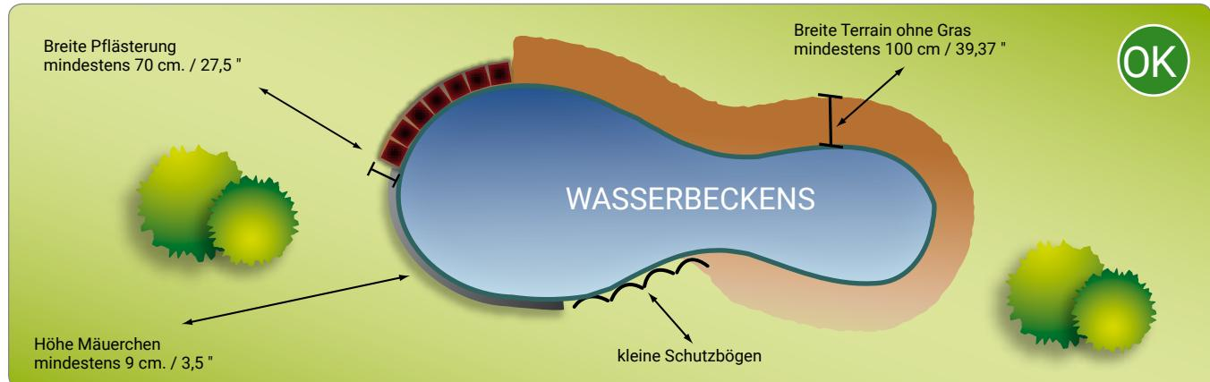
Die Abbildung oben zeigt einen Arbeitsbereich, der für ein optimales Funktionieren des Roboters richtig abgegrenzt ist.
