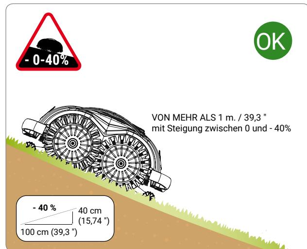
Der Roboter kann Höhenunterschiede mit einem Gefälle bis 40 % bewältigen und dabei den Rasen optimal zu mähen, die Leistung sinkt jedoch in einem höheren Abstand von dem Maß.
