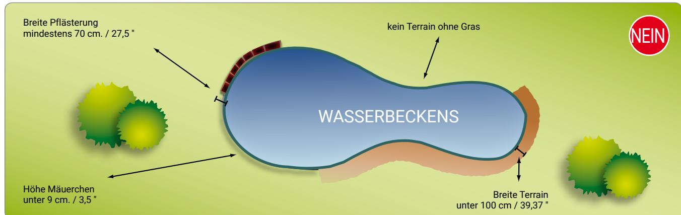
Die Abbildung oben stellt einen Arbeitsbereich dar, wo der Betriebsbereich des Roboters nicht korrekt begrenzt wurde, so dass er nicht richtig funktionieren kann.
