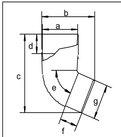
Mit Hilfe des Bogens 67° sind Verbindungen zwischen Fallrohr und Stutzen oder zwischen zwei Fallrohren möglich. Zur Verbindung von zwei Bögen muß ein Fallrohrstück oder der Bogenverbinder zwischengesetzt werden.
