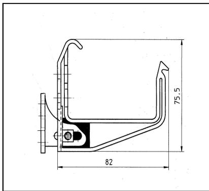
Der verstellbare Rinnenhalter ist in einem Abstand von 50 cm direkt am Stirnbrett zu befestigen und mit einer Richtschnur so auszurichten, dass die Dachrinne ein Gefälle von 2 bis 3 cm pro 10 m Rinnenlänge aufweist. Der Rinnenhalter kann in einem Bereich bis 25° geneigt werden.
