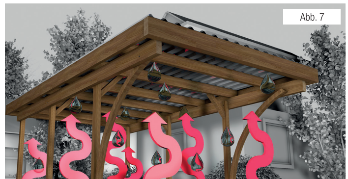
Feuchtigkeit steigt nach oben und bildet Kondenswasser, das ohne richtige Lüftung vom Dach abtropfen kann. Deshalb muss für ausreichend Luftstrom gesorgt werden.
