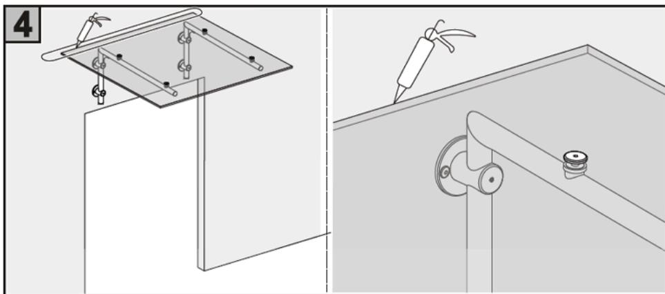
2. Verschrauben Sie jetzt die Halter mit der Hauswand. In der Regel werden dafür 8mm Gewindestangen in die Fassade eingeklebt. Bei Fragen helfen wir gern.
