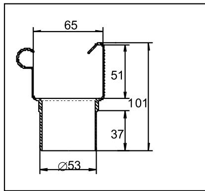
Die Dachrinne wird ungeteilt durch den Stutzen geführt, wobei ein Loch für den Wasserablauf in die Dachrinne gesägt oder gebohrt wird. Der Stutzen kann über eine Fallrohrmuffe mit dem Fallrohr oder direkt mit einem Bogen verbunden werden.
