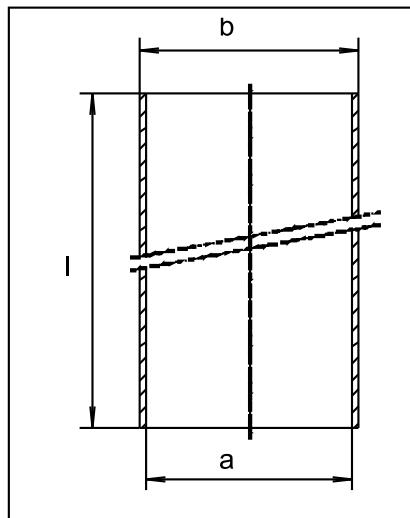
Fallrohre müssen mit einer separaten Rohrmuffe verbunden werden.
