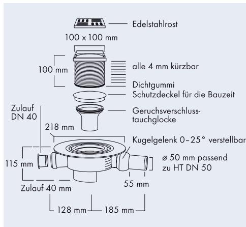
**Bad-, Boden- und Deckenablauf,** aus PP (Polypropylen) mit Geruchsverschluss und Edelstahl-Rost. Waagerechter Abgang DN 50. Zusätzlich besteht die Möglichkeit, auf der gegenüberliegenden Seite ein Abwasserrohr DN 40 anzuschließen.
