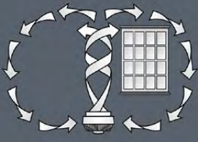
Tauscht die kalte Bodenluft mit warmer Deckenluft aus
