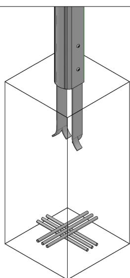
Platzieren Sie den Betonstahl in den Fundamenten, stellen Sie die verschraubte Rinnenkonstruktion in den Fundamentlöchern auf und richten sie darin mit Hilfe von Holzlatten und einer Wasserwaage aus.
