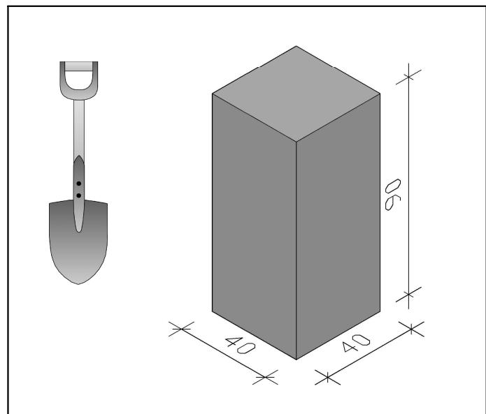
Messen Sie die Fundamente ein und heben Sie die Löcher entsprechend 90cm tief (frostfrei) aus.
