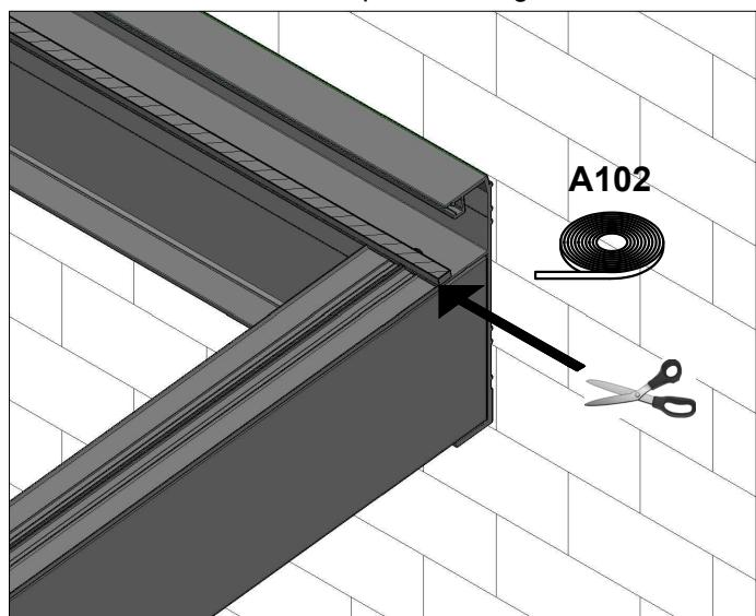
Kleben Sie das Fugenband auf die Enden des Profils der Rinnen- und der Wandpfette auf und schneiden es dann seitlich bündig mit den Sparren ab.
