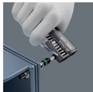
Der Bit-Check selbst kann auch als Hebel genutzt werden.
