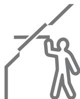
Manuelle Schwingfenster mit Obenbedienung bieten die Möglichkeit, Möbel direkt unter dem Fenster zu platzieren, ohne die Bedienung des Fensters zu beeinträchtigen. Wir empfehlen eine Einbauhöhe, die sowohl in stehender als auch in sitzender Position eine klare Sicht nach außen ermöglicht. Bitte beachten Sie, dass die optimale Fensterhöhe von der Dachneigung abhängt.
